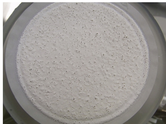
図 14b 発泡により安定しないろ過ケーキ
