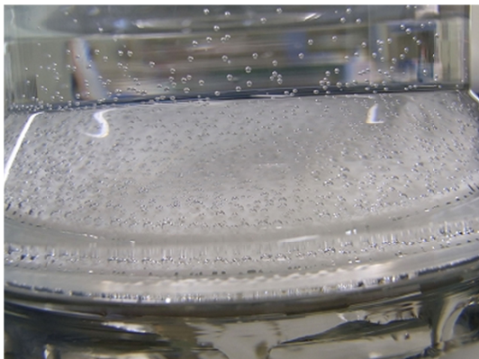
図 14a ろ過中に発生した気泡
