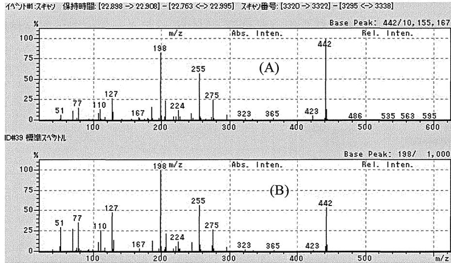
図 5-2 デカフルオロトリフェニルホスフィン (DFTPP)のマススペクトル
