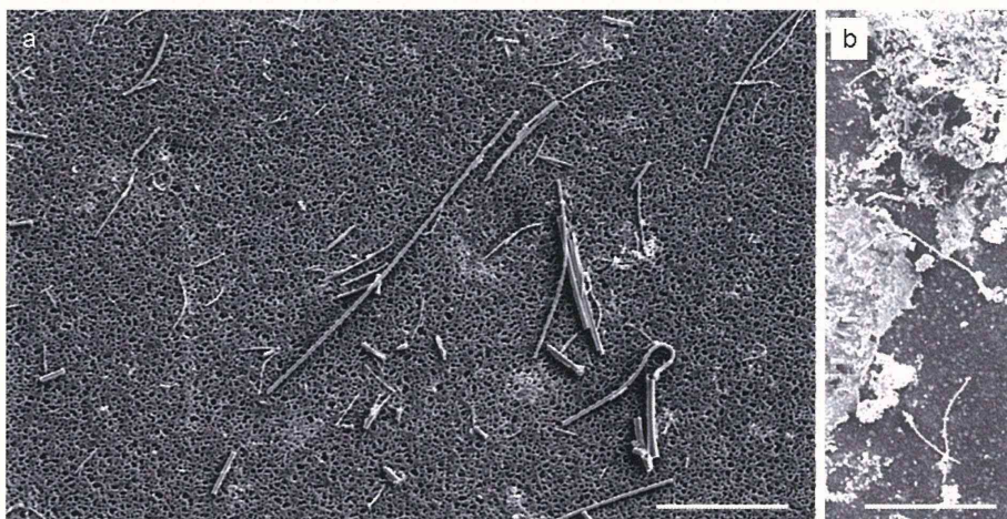
図 13 肺から抽出した MWCNT の走査型電子顕微鏡像
