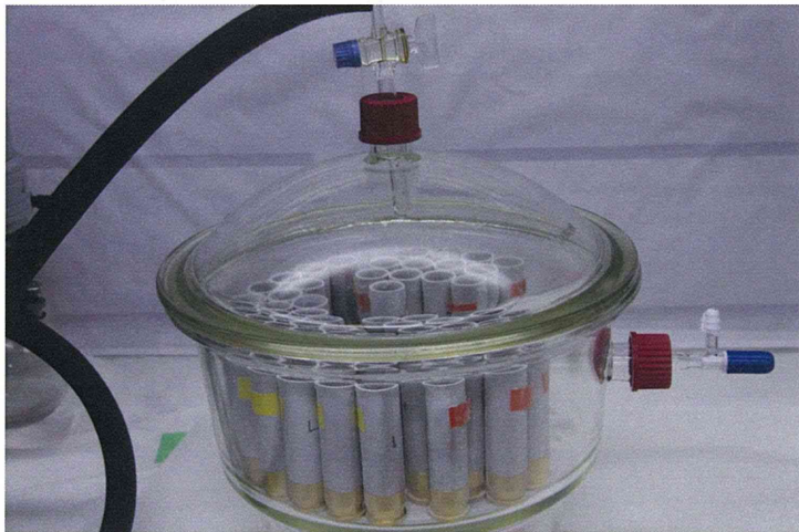
図5 T-CNTのカートリッジへの充填方法
