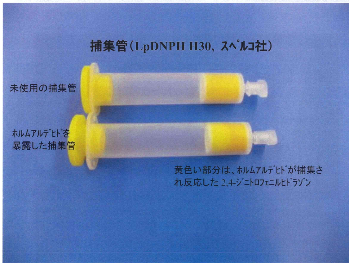
図ホルムアルデヒド-5. ホルムアルデヒドを暴露し、捕集管に捕集され、反応した2,4-ジニトロフェニルヒドラゾン
