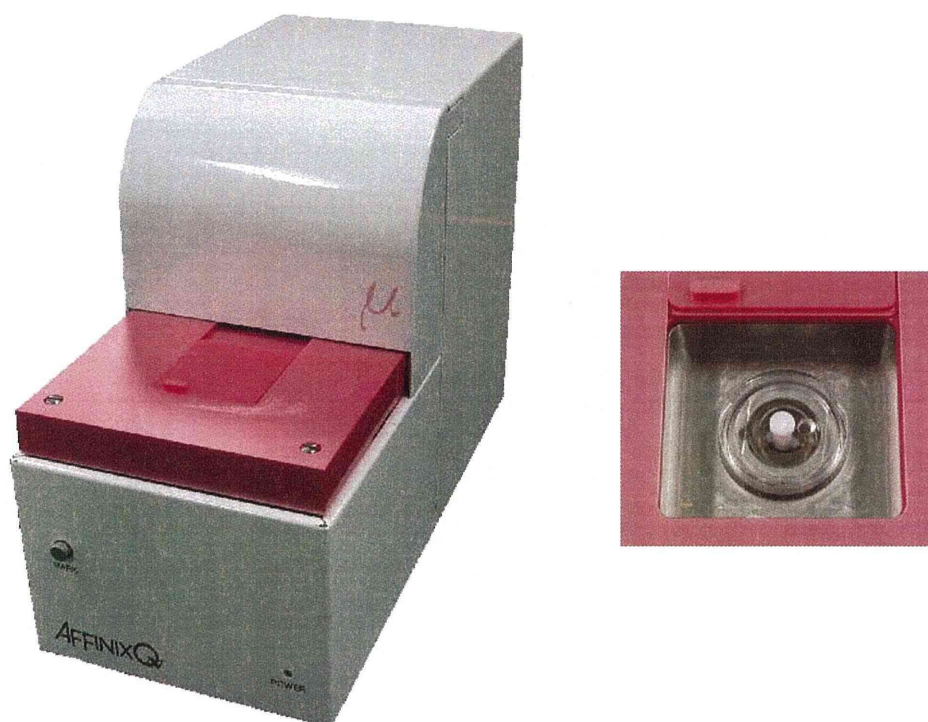
図3 QCM装置の外観（左）及び測定部（左）
