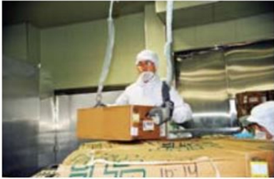
腰痛予防のため株吉野家東京工場に導入された「ラク ラクハンド」。30kgまでの持ち上げを補助できる
