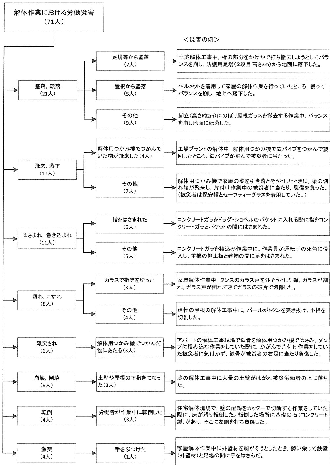
図4 解体作業における労働災害の概要
