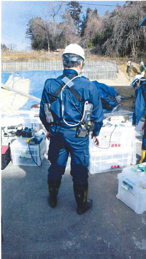
写真8 個人ばく露測定のための装備
