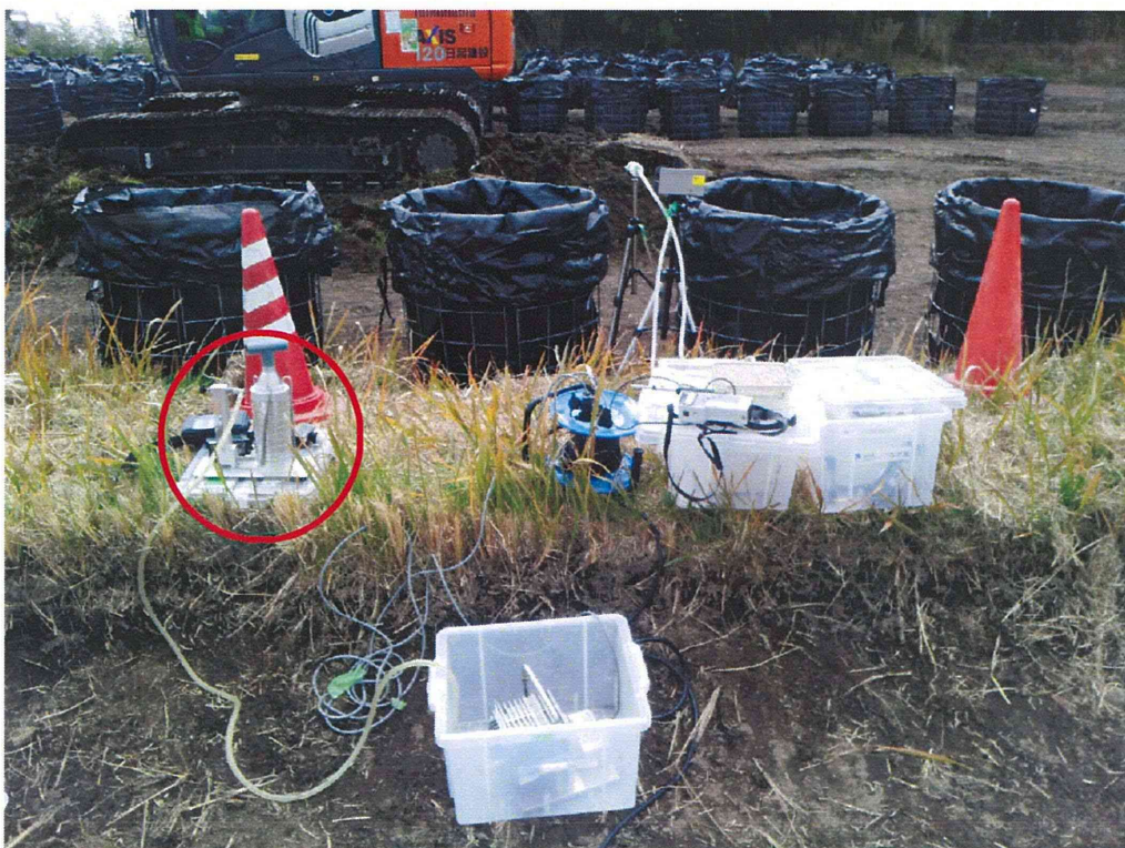
写真2 定点における粉じん計測（赤丸はアンダーセンサンプラー）
