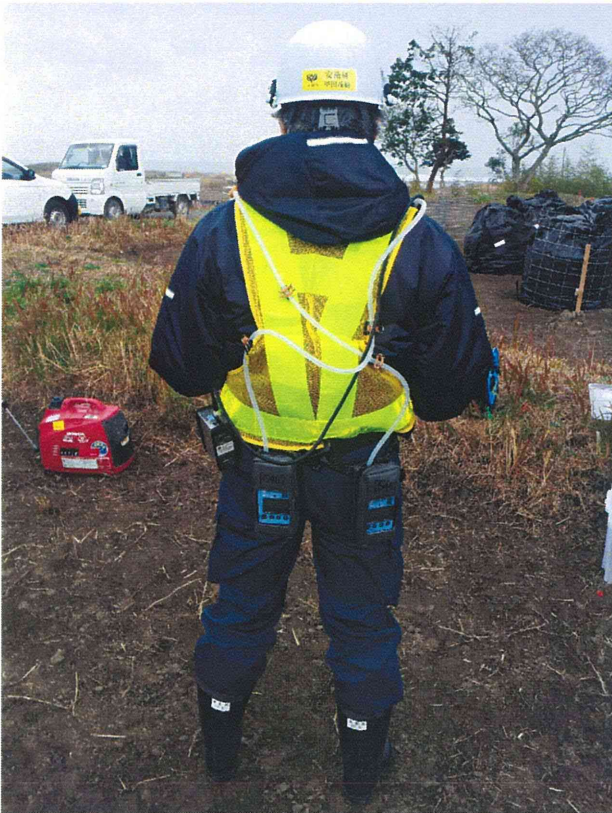
写真3・4 個人ばく露測定の装備
