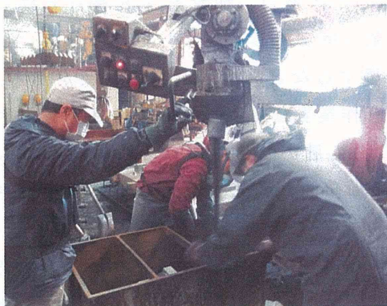
図 2.1 手込め作業風景
