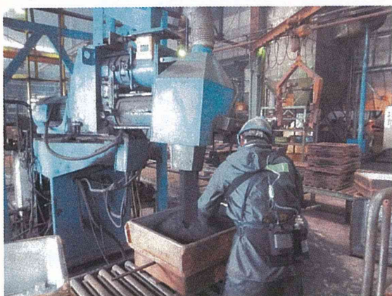
図 2.3 手込め作業風景
