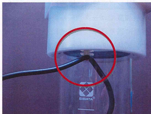
写真 26 ギ酸ミスト発生装置の問題点 (1)
