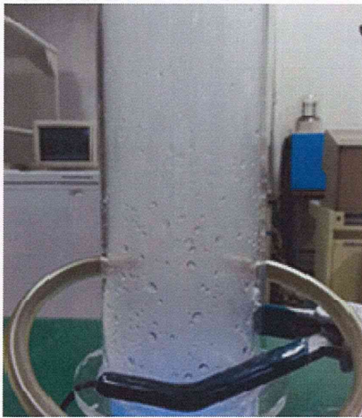
写真 28 ギ酸ミスト混合部分の内壁の状況
