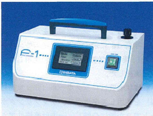
写真 16 リアルタイムモニター F-1 (柴田科学株式会社製) の外観
