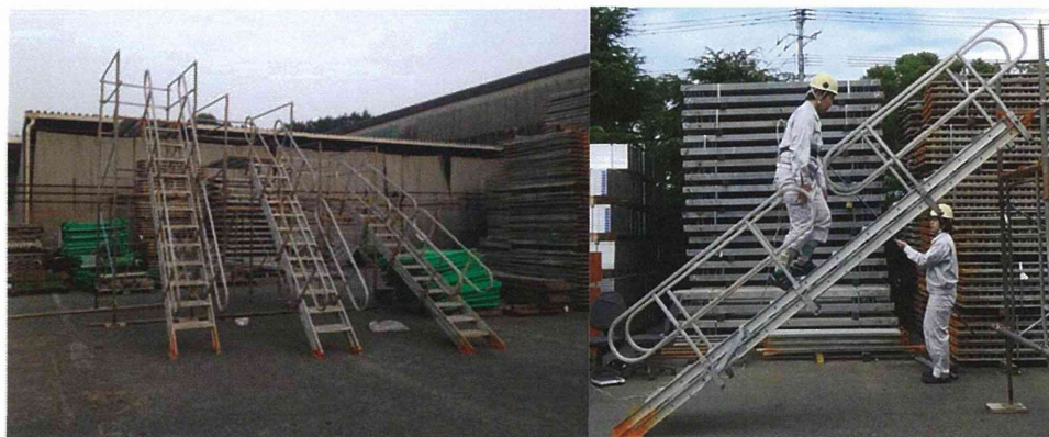
図 C-2-5-1 仮設階段の概観と歩行実験の様子
