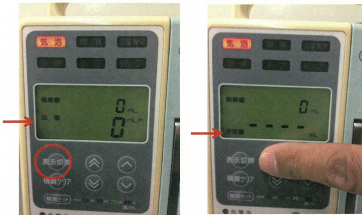
↑ 輸液ポンプ TE-112 流量と予定量の表示部が同じ であるため注意(表示切替ボタンで切り替える)
