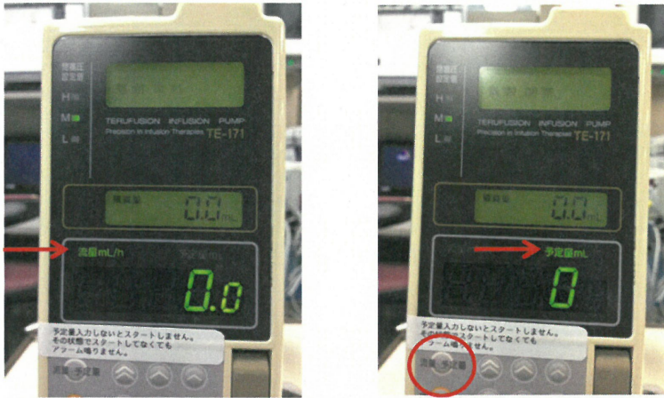
↑ 輸液ポンプ TE-171 流量と予定量の表示部が同じ であるため注意(流量・予定量ボタンで切り替える)
