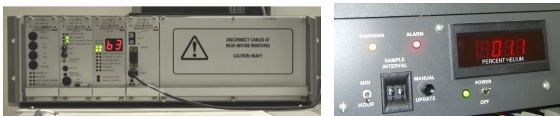
左は他の機能機器との組み合わせ型 右は液面計単独型 AC100V で単独動作可能
