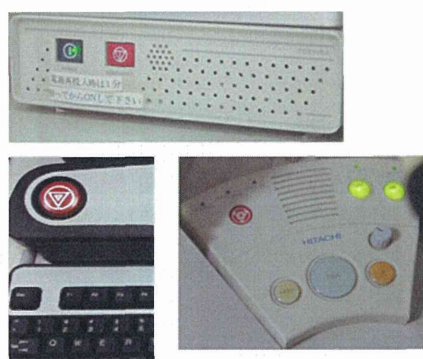
図2 緊急撮影停止ボタンの例 デザインは似ているが、配置されている場所はメーカーにより異なる。
