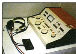
佐藤恒正博士とリオン社によって開発された方向感自動記録装置(TD-01)
