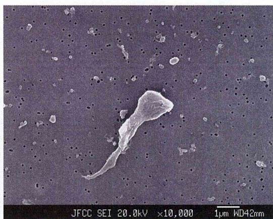
図 5. 32 mmφCoCr 骨頭と組み合わせた MPC 処理 CLPE+E(Aging)ライナーから発生した摩耗粉
