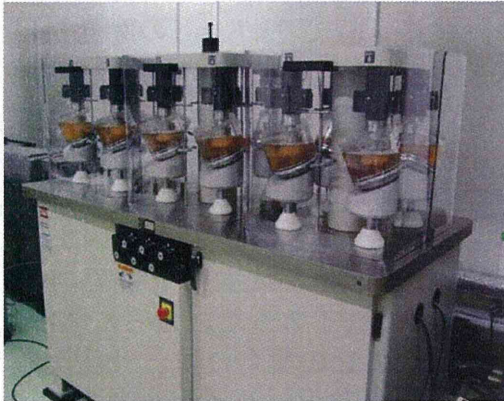
図 1. 股関節シミュレーター全体像
