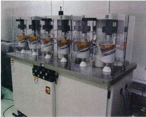
図 1. 股関節シミュレーター全体像
