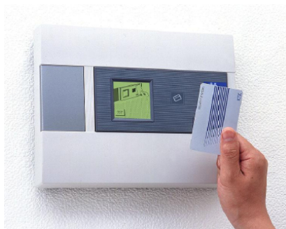
図 2. 入退室認証装置
