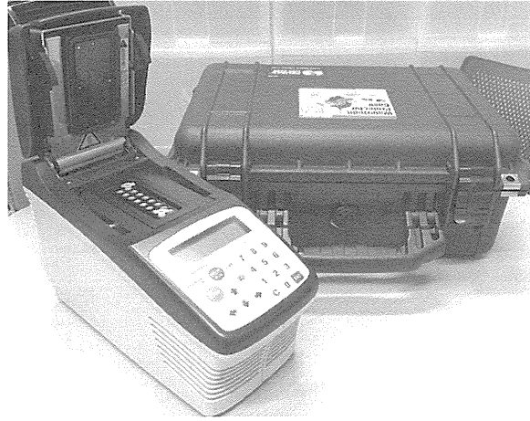
図22 モバイル型遺伝子増幅装置とキャリーバッグ
