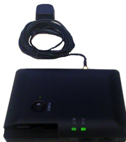
図1：QZSS 対応 GNSS 受信機
