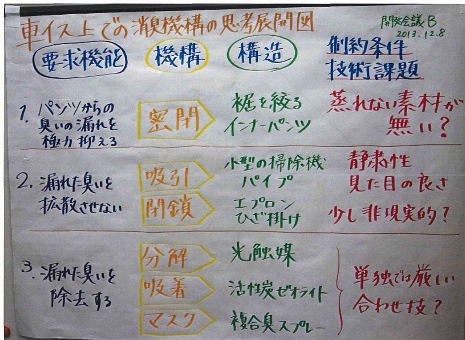
図6 要求機能のまとめと機構・構造への展開。
