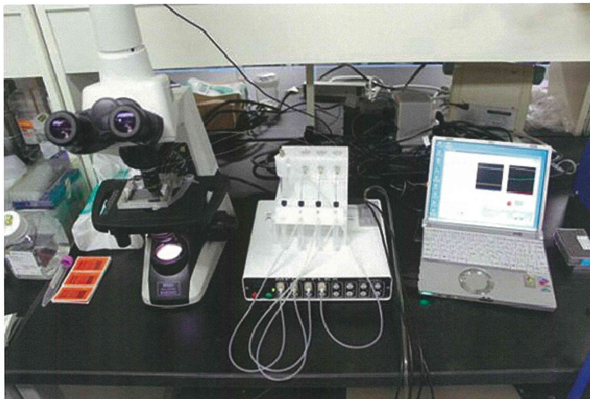
図 2 6 循環がん細胞診断デバイスのプロトタイプ
