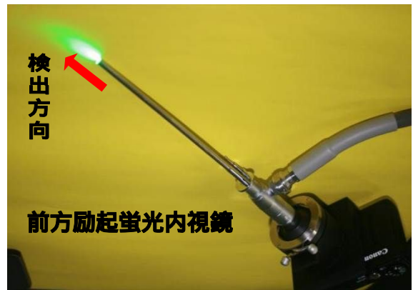
図7. プロトタイプ蛍光内視鏡。上は管壁、腹壁など90度側面を観察・光照射することができる。下は在来型の直進方向を観察・光照射する腹腔鏡である。青色光は430nmのXenonの光。
