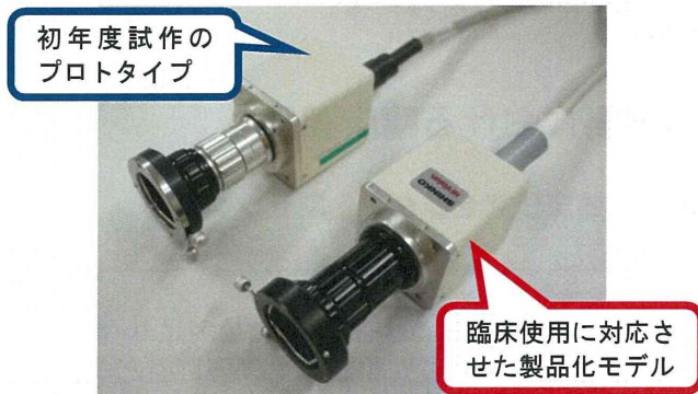
Fig. 1 CMOS 撮像素子を用いた超高感度内視鏡カメラヘッド. 左上) 初年度試作のプロトタイプ. 右下) 今年度製作の製品化モデル.
