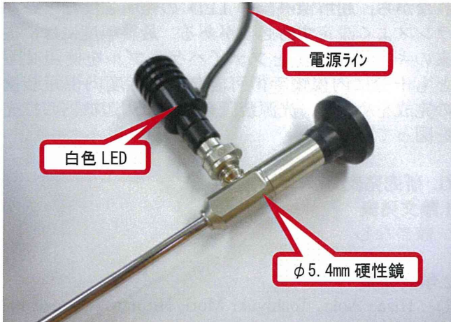
Fig. 4 外径 5.4mm 硬性鏡と白色 LED 装置
