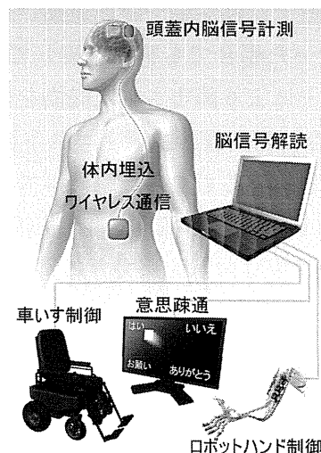
図1 ブレイン・マシン・インターフェース (BMI) の概念図(体内埋込型BMIを示す。)
