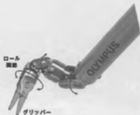
図4 ロール関節を有する先端3自由度処置具
