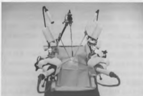
図3 1メートル四方に内視鏡を含め5本のアームを配することができる。
