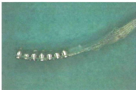
図1. STS方式の弾丸電極。弾丸のように突出した形状を持っている。
