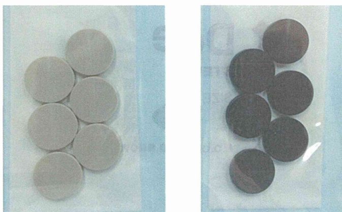
図 5-4 \phi 14mm の PEEK (左) と 7% CNT-PEEK (右)
