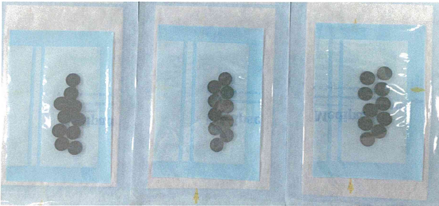
図 5-1 CNT 添加 PEEK 材 (CNT/PEEK) 左 3% 中 5% 右 7%
