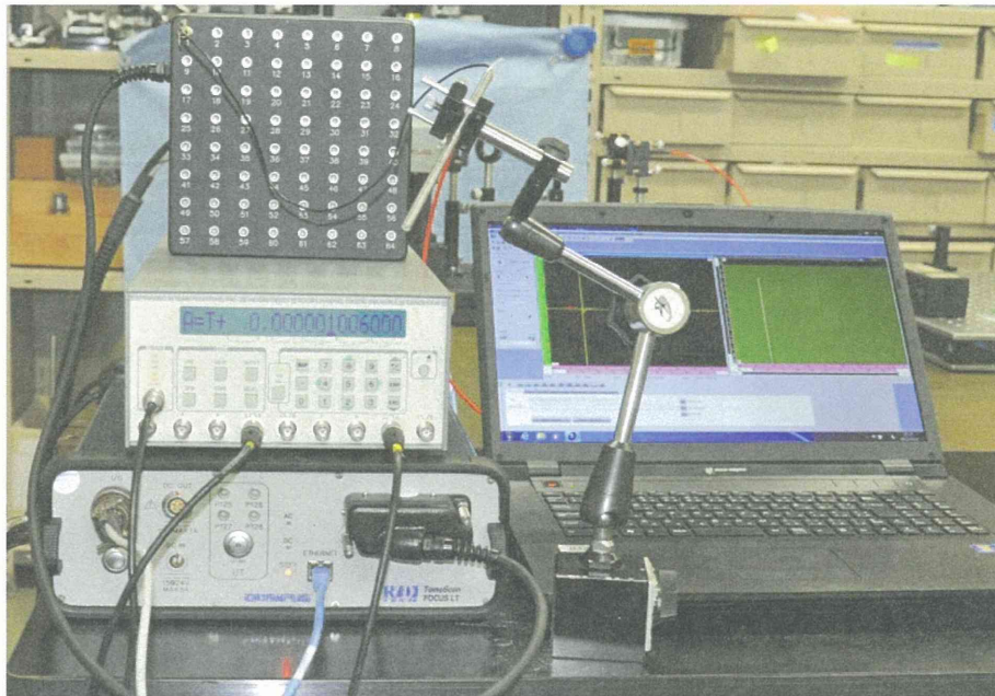
図6 多チャンネルパルサーシーバーへの自作探触子の接続。アレイ型探触子用の接続端子を専用アダプタにより最大64個のLemo00コネクタに変換し、そのコネクタにP(VDF-TrFE)製の自作探触子(単素子)を接続している。
