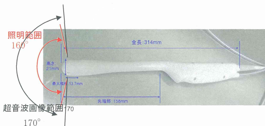
図4 経直腸プローブの外観形状
