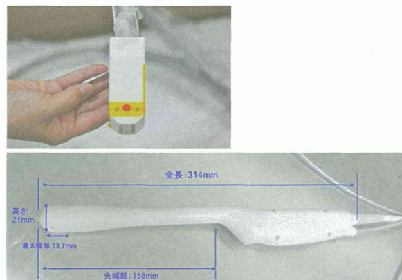
図 2 光音響リニアプローブと経直腸プローブの開発
