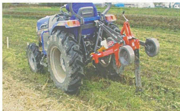
図2 振動型サブソイラ型ストロン切断機（刃がトラクタの前後に振動する）
