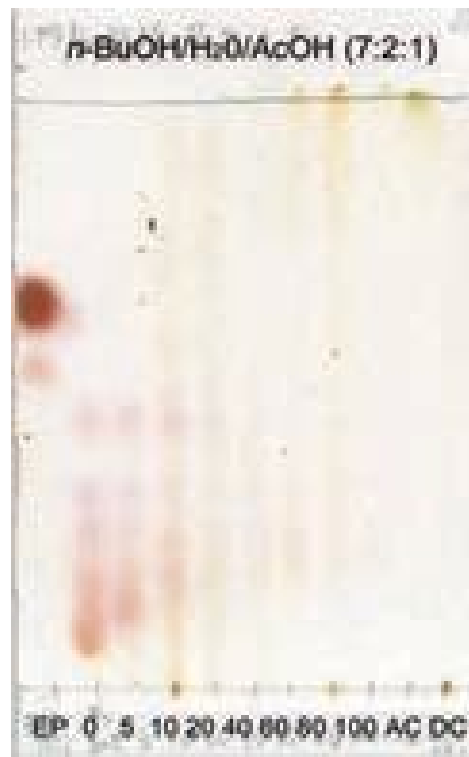
図5 . イオン交換樹脂分画物の Si-TLC プロファイル (ニンヒドリン呈色)
