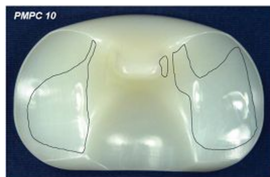
(b) PMPC 処理 CLPE の摺動表面 図 14 試験後の CLPE インサートの摺動表面写真
