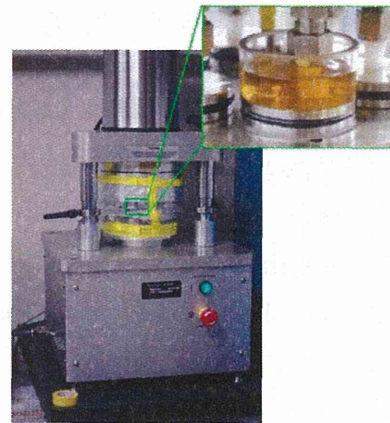
図 2. Pin-on-disk 型摩耗試験装置 (AMTI 製 Ortho-POD)
