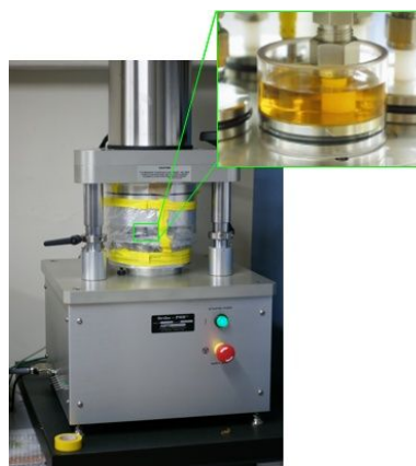
図 2. Pin-on-disk 型摩耗試験装置 (AMTI 製 Ortho-POD)
