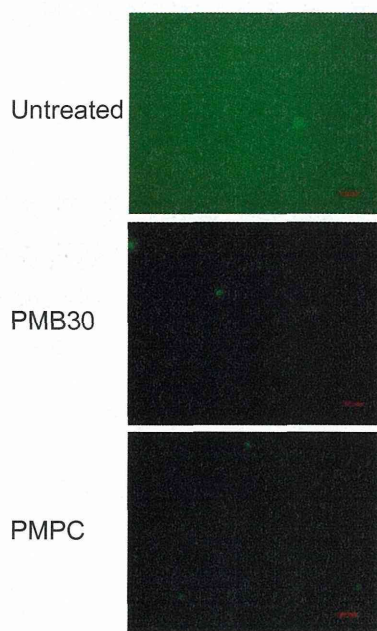
図7. PBS中で黄色ブドウ球菌と接触させたCo-Cr-Mo合金表面の蛍光顕微鏡観察像(200倍)
