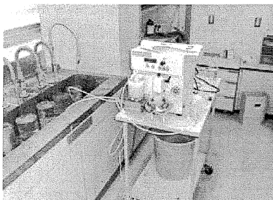
写真 7 加圧ろ過、あるいは吸引ろ過方式による粉体ろ過法
