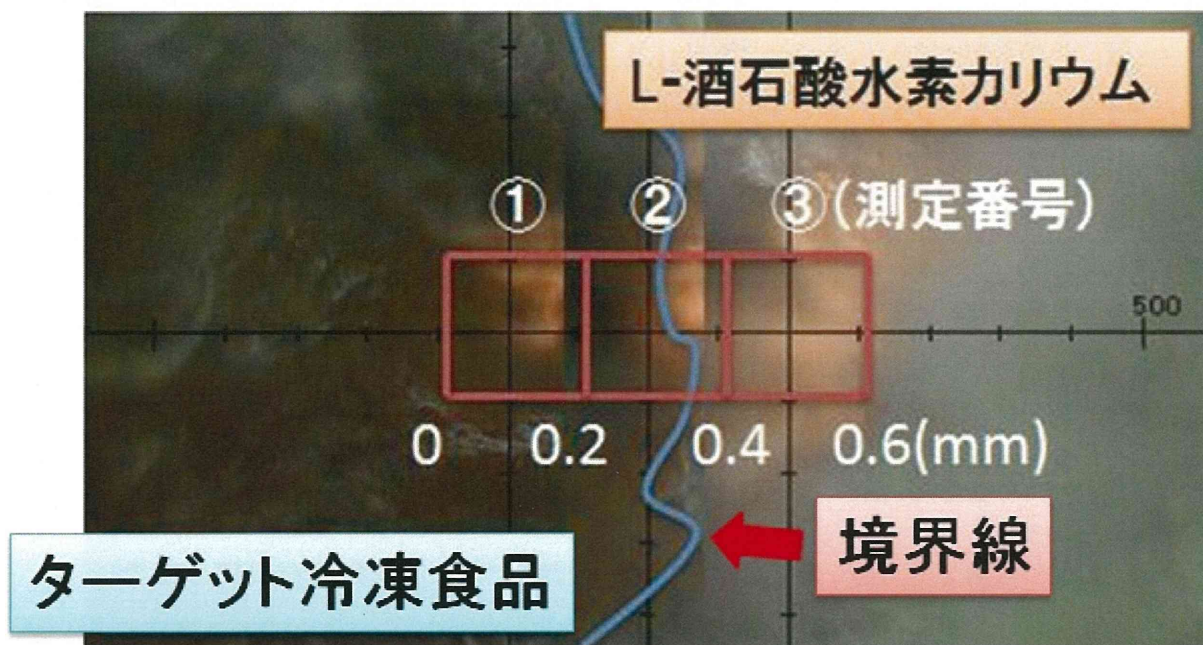
図 3 1 ESC 候補物質(L-酒石酸水素カリウム)のプリント部のエッジ (境界線) 検出
