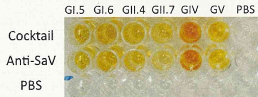
図2. サンドウィッチ ELISA 法 GI.5:Yokotel, GI.6:Nichinan, GII.4:Kumamoto6, GII.7:20072248, GIV:Yakumo8, GV:NK24, Cocktail:616+1803+Y1A8+1496 Cocktail 抗体および Anti-SaV 抗血清を固相化抗体とし、各 VLPs を 反応後、捕捉抗体としてビオチン化抗体 Y2A4 を添加した。
