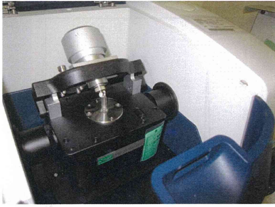
図 14. バイアルインサートによる液体試料保持の写真と模式図
