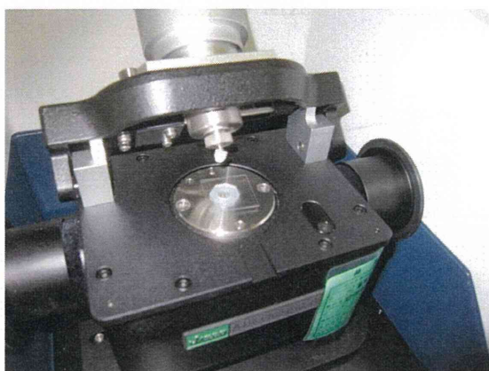
図 10. 自作シリコンシート製液溜め（カバーガラス蓋）の写真及び模式図
