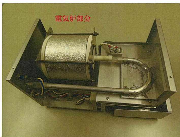
写真 66 市販の有機質除去処理装置の加熱部分の概要
