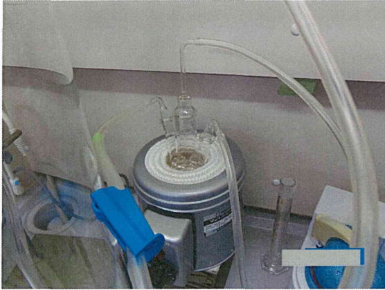
写真 78 加熱した除去処理装置の概要
