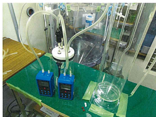
写真 72 サイクロン方式の分粒装置による粒子状物質の除去の概要
