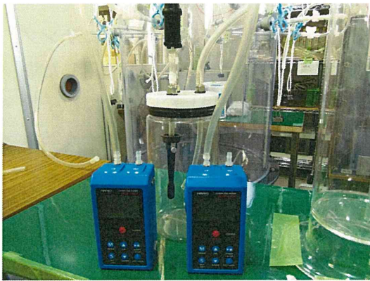
写真73 サイクロン方式の分粒装置による粒子状物質の除去の概要
