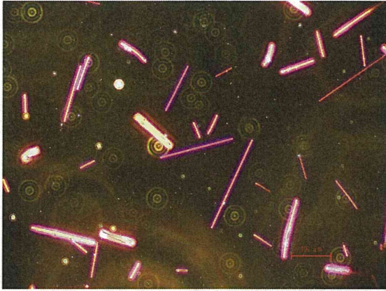
写真 31 ロククワール (浸液 : 1.620 100 倍)
