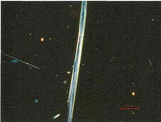
写真 27 ケブラール 600°C (浸液 : 1.550 100 倍) 写真 28 ケブラール 600°C (浸液 : 1.550 400 倍)
