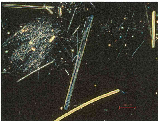
写真 29 ケブラール 700°C (浸液 : 1.550 100 倍) 写真 30 ケブラール 700°C (浸液 : 1.550 400 倍)
