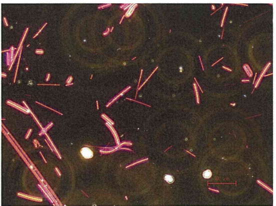
写真 35 ロククワール 500°C (浸液 : 1.620 100 倍)
