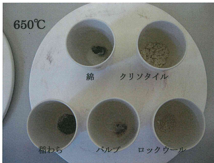
写真 19 650°Cの時の各繊維加熱処理後の状況
