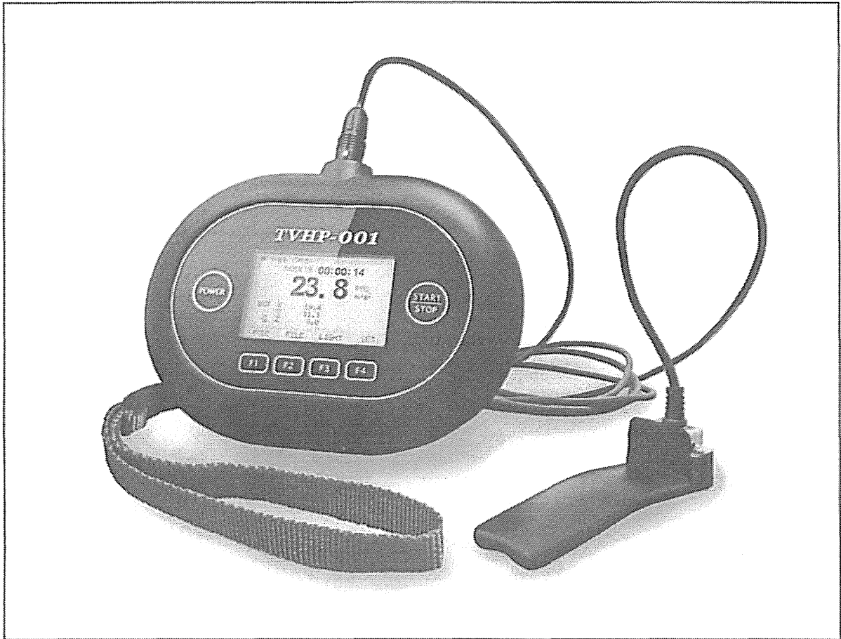
図1 今回開発した振動工具管理者向け手腕振動計測装置
