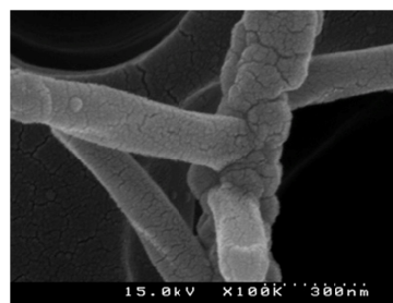
図 1.74 MWCNT, 1.0 \times 10^{-6}\text{wt}\% の FE-SEM 観察結果(100000 倍)
