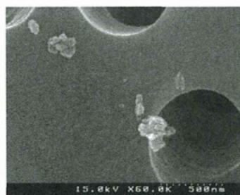
図 6.19 清掃作業時のオープン②による粒子捕集例 (60000 倍)
