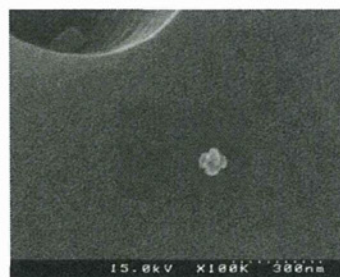
図 6.20 清掃作業時のオープン②による粒子捕集例 (100000 倍)
