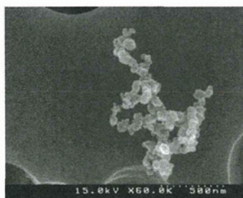
図 6.16 充填作業時の Sioutas (E 層) による粒子捕集例 (60000 倍)
