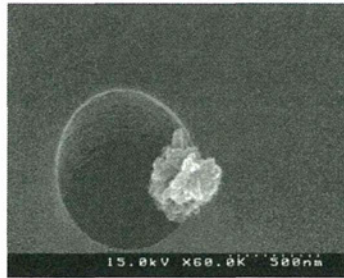
図 6.22 清掃作業時の Sioutas (E 層) による粒子捕集例 (60000 倍)
