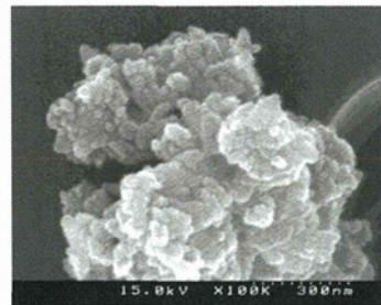
図 6.28 充填作業時の LD-6N による呼吸器付近の粒子捕集例 (100000 倍)
