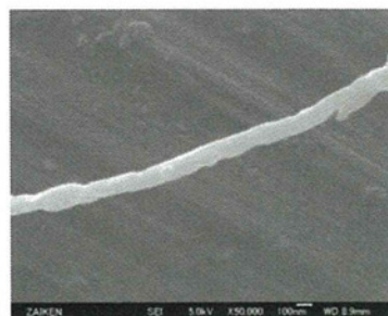
図 5.31 サーマルプレシピテーター (測定点①×50,000)
