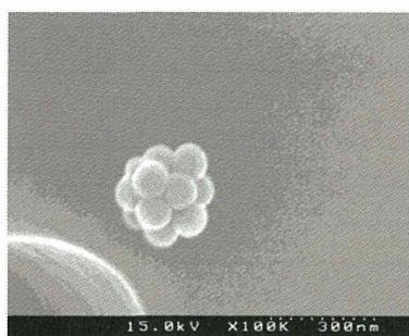
図 4.15 L2W(RL2)を通過した粒子(凝集体)(ポリスチレンラテックス粒子)
