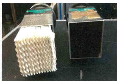
図 3.30(a) サンプルホルダーにセットした HEPA フィルター内部
