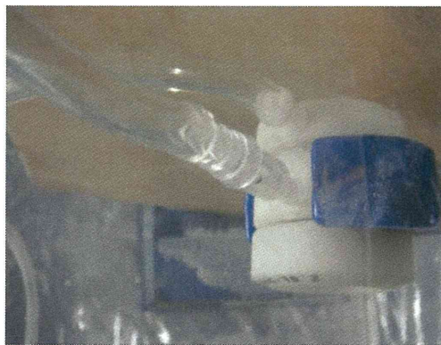
図 3.13(c) 吸引ポンプ及び圧損計との接続時のオープンフェイスサンプラーの外観
