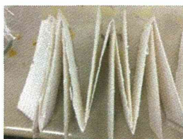
図 3.4(a) 上方から見た HEPA フィルター内部
