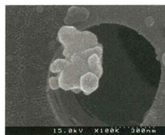
図 1.102 銀ナノ粒子の 1.0 \times 10^{-6} \text{wt}\% FE-SEM 観察結果(100000倍)
