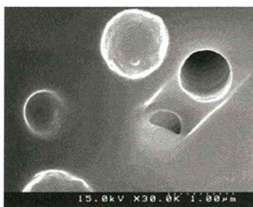
図 1.67 分散剤溶液の FE-SEM 観察結果(x30000)
