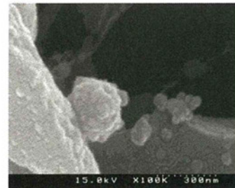
図 1.89 フラーレン 1.0×10 -4 wt%の FE-SEM 観察結果(100000倍)
