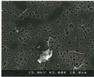
図 1.72 MWCNT, 1.0 \times 10^{-6} wt%の FE-SEM 観察結果(3000 倍)
