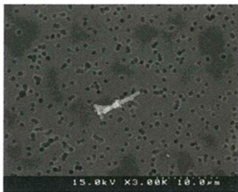
図 1.77 MWCNT, 1.0 \times 10^{-8} wt%の FE-SEM 観察結果(3000 倍)
